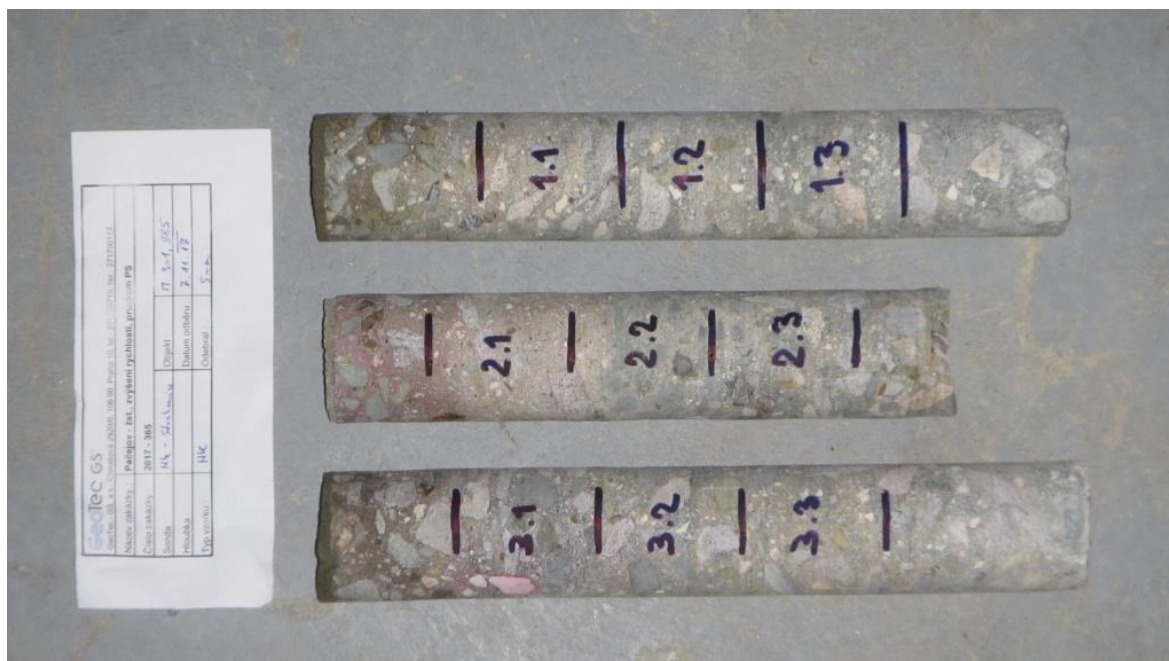
Laboratorní foto vzorků jádrových vývrtů o průměru 55 mm s vyznačenou polohou zkušebních těles před jejich zakončováním na pile s diamantovým řezným kotoučem
