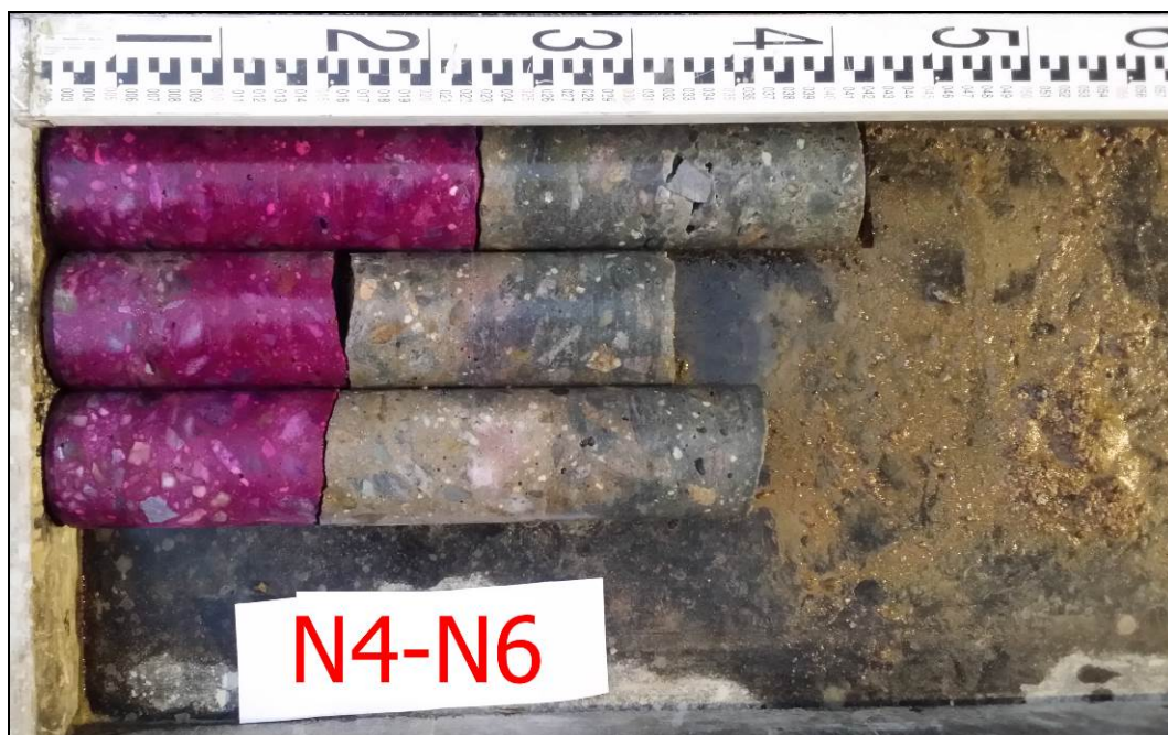
Obr. č. 6 - diagnostické návrty N4-N6 (shora dolů); po aplikaci roztoku fenolftaleinu.
