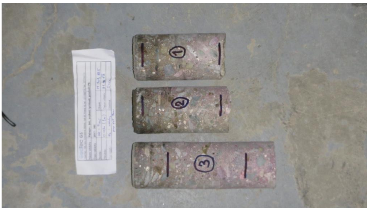
Laboratorní foto vzorků jádrových vývrtů o průměru 75 mm s vyznačenou polohou zkušebních těles před jejich zakončováním na pile s diamantovým řezným kotoučem
